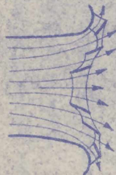
Rys. 20. Dyfuzor wylotowy z łopatkami gładkimi o kształcie pierścieniowym wg Darrieusa
