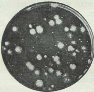
Kulturplatte aus dem Zuführungsrohr für frische Außenluft 51) .
