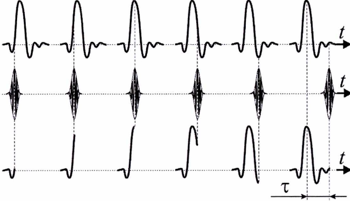
Rys. 3.46. Rekonstrukcja terahercowego impulsu pomiarowego E_{\text{med}}^{\text{THz}}(t) (górna seria), który przeszedł przez materiał badany, laserowym impulsem próbkującym E_{\text{prob}}(t) (środkowa seria), o narastającym czasie opóźnienia \tau względem siebie. Dolna seria – wynik rekonstrukcji impulsu terahercowego metodą koherentnej detekcji homodynowej
