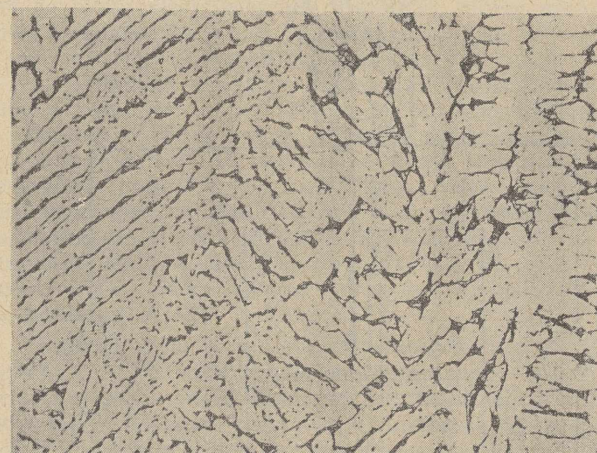
Rys. 7. Struktura mosiądzu + pol. mech. traw. 10 % wod. roztw. \text{FeCl}_2 . Pow. \times 125
