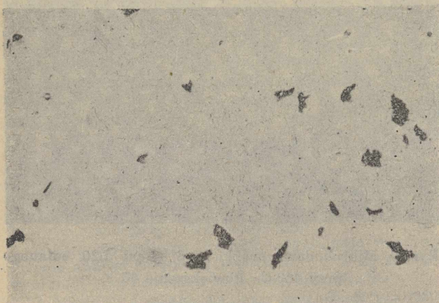
Rys. 2 — Elektrolityczny proszek miedzi otrzymany przy gęstości prądu 15 A/dm 2 . (Pow. 550X)
