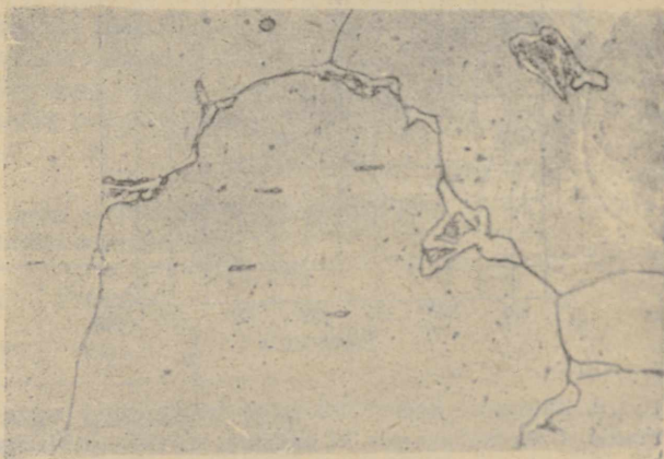
Rys. 5. Struktura blachy jak na rys. 4. Traw. HNO_3 . Pow. 800 x
