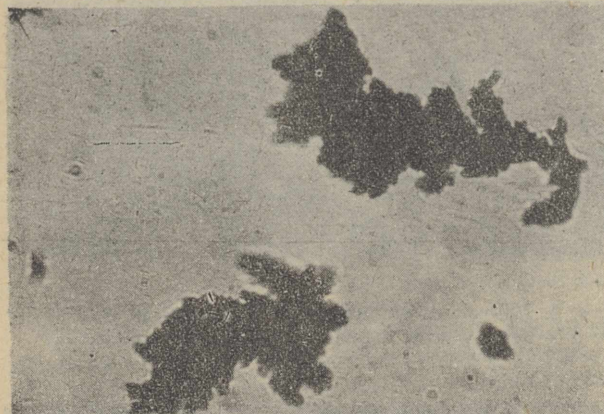
Rys. 1 — Elektrolityczny proszek miedzi otrzymany przy gęstości prądu 7 A/dm 2 . (Pow. 550X)
