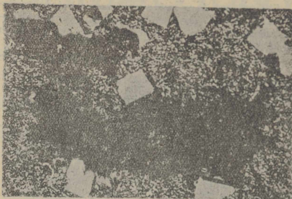
Rys. 2. Mikrobudowa próbki nr 2 stopu Ł20 wygniecionego w czasie pracy. Powiększenie 65×
