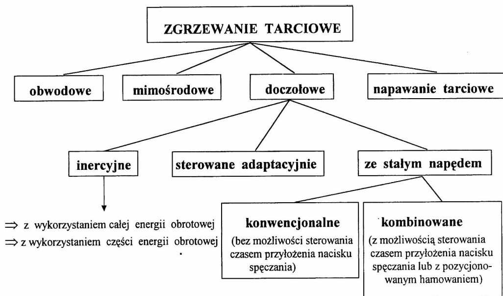
Rys. 3.3. Klasyfikacja metod zgrzewania tarciowego [73]
