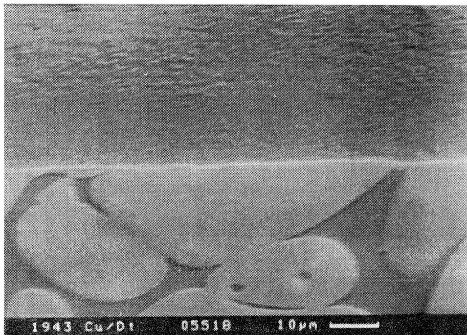
Rys. 10.24. Mikrostruktury złącza niob–pseudostop wolframu D18 z przekładką z miedzi: całość połączenia (mikroskop optyczny) (a), złącze miedź–pseudostop wolframu D18 (mikroskop optyczny) (b) i mikroskop skaningowy (c)
