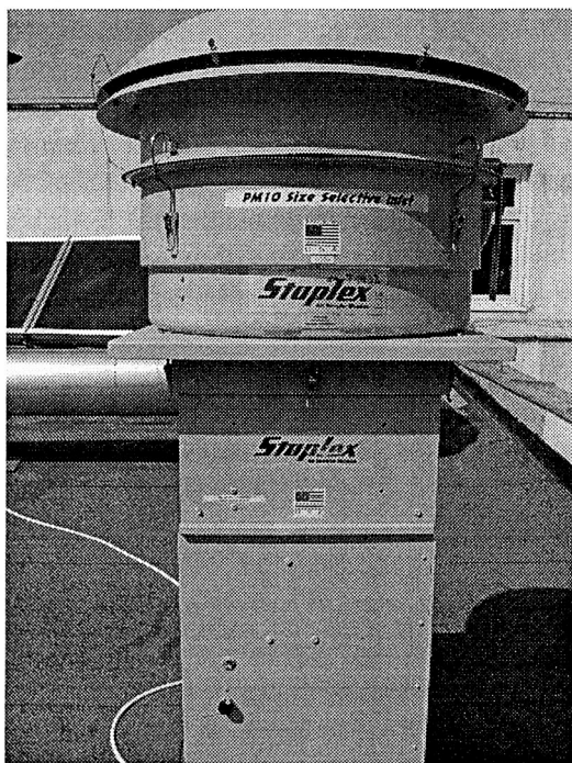
Rys. 2. Wysokoprzepływowy aspirator powietrza firmy Staplex PM10 model FC-2ETM
