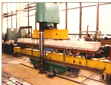
Rys. 110. Belka podczas badań pod obciążeniem: a) statycznym, b) cyklicznym
