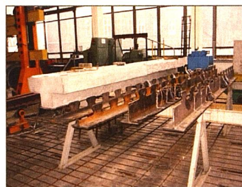
Rys. 109. Elementy składowe konstrukcji przygotowane do zabetonowania oraz stalowe belki z wysokim i niskim średnikiem na tle wykonanej belki zespolonej o przekroju C3
