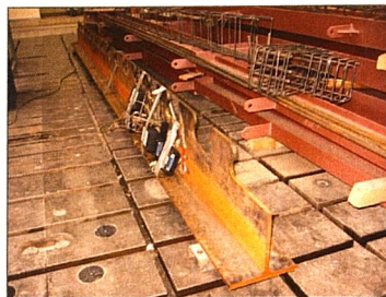
Rys. 107. Belki stalowe i oprzyrządowanie do pomiaru odkształceń
