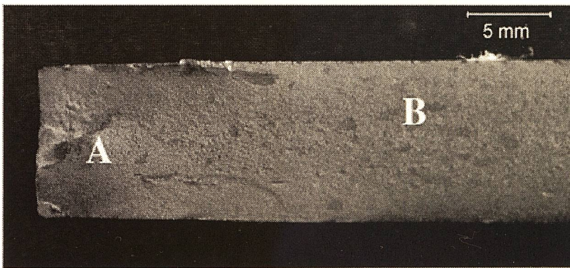
Rys. 72. Widok ogólny powierzchni obszaru 1; A – obszar strefy zmęczeniowej w pobliżu krawędzi blachy, B – obszar strefy doraźnej [11]
