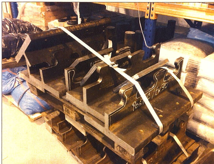
Rys. 87. Konstrukcja stalowa elementów typu POST – środniki o grubości 30 mm
