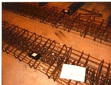
Rys. 108. Tensometry elektrooporowe na belce stalowej i zbrojeniu
