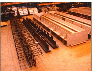
Rys. 109. Elementy składowe konstrukcji przygotowane do zabetonowania oraz stalowe belki z wysokim i niskim średnikiem na tle wykonanej belki zespolonej o przekroju C3
