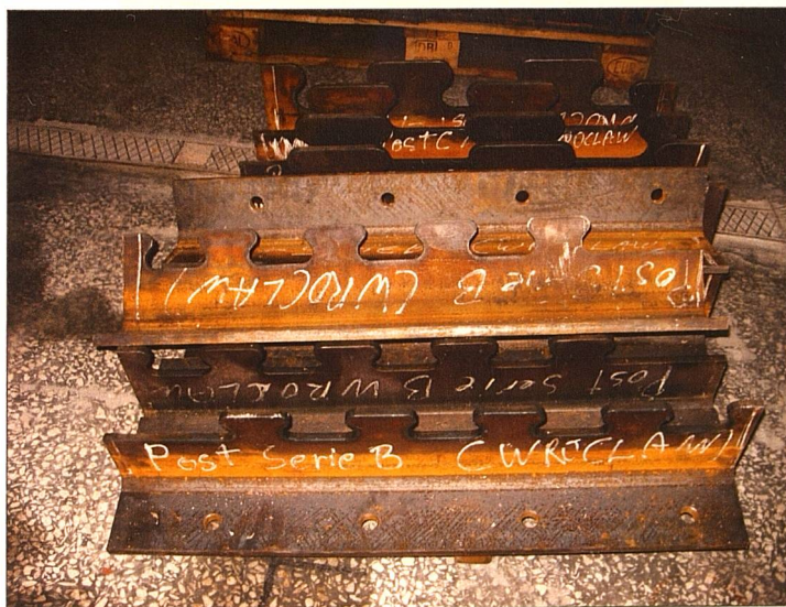
Rys. 88. Konstrukcja stalowa elementów typu POST próby typu B
