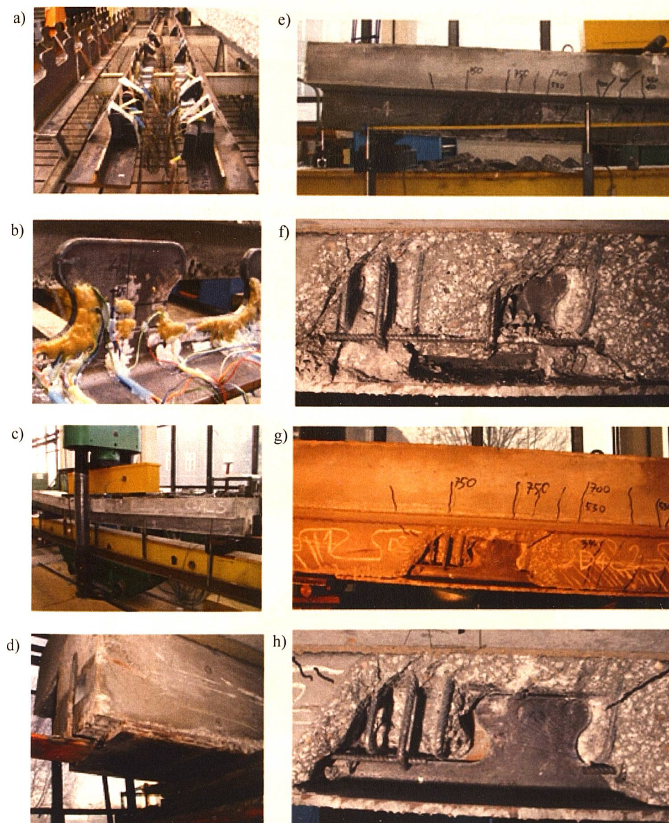
Rys. 111. Belka C3/2LS podczas badań jako kluczowa ze względu na KNS:
