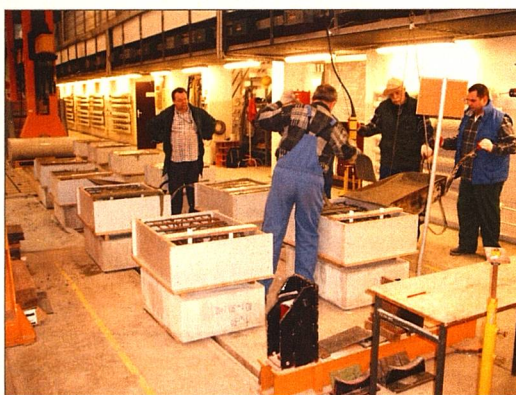
Rys. 90. Realizacja elementów do badań – betonowanie drugiej płyty
