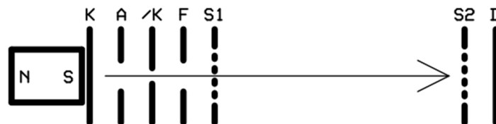
Rys. 106. Układ elektrod w spektrometrze ToF; K – katoda, A – anoda, /K – antykatoda, F – elektroda sterująca, S1 i S2 – siatki na końcach strefy dryftu, D – detektor jonów.
