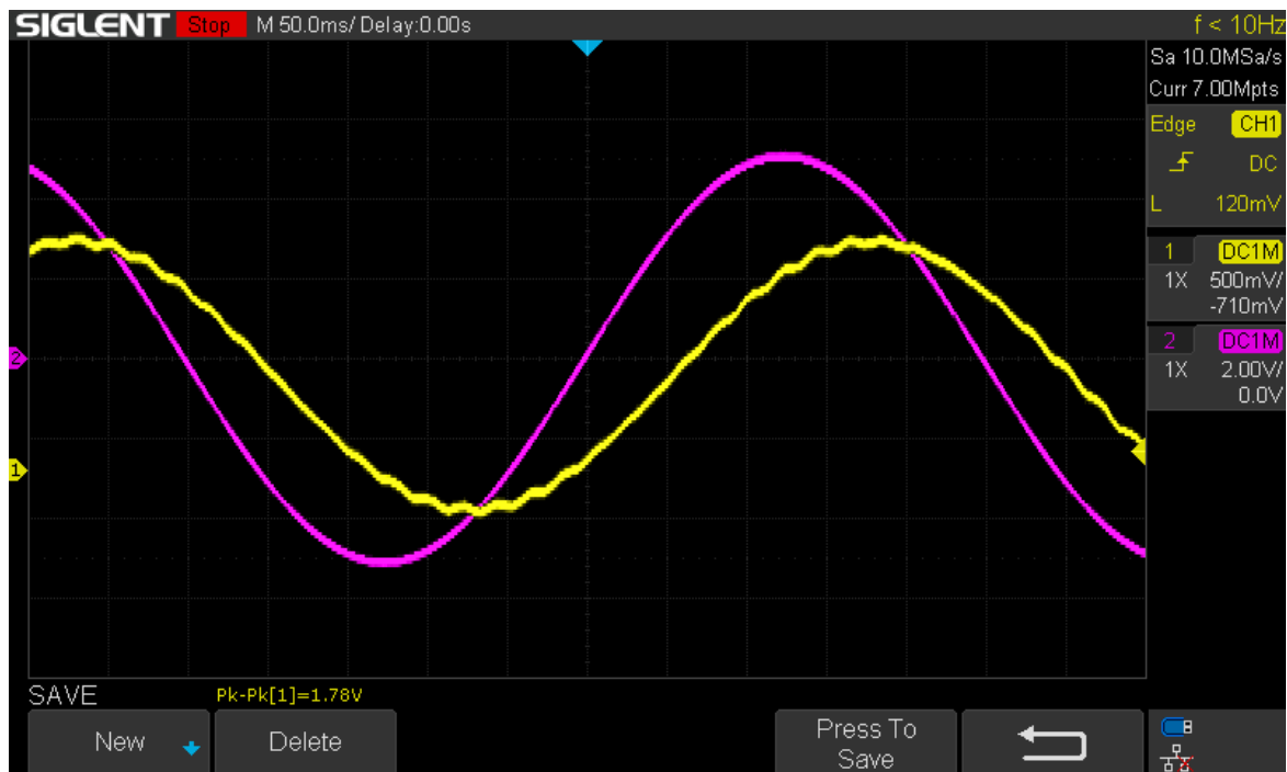
Rys. 55. Sygnał wyjściowy (żółty, 500 mV/dz.) i wejściowy (fioletowy, 2 pA/dz.) w trakcie badania pasma przenoszenia i oceny poziomu szumów.
