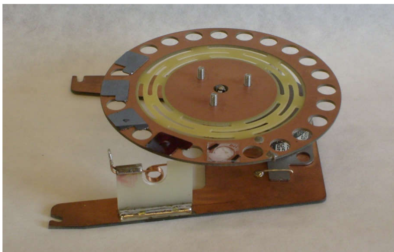
Rys. 60. Manipulator obrotowy z miejscami na 24 próbki.
