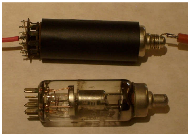
Rys. 121. Kenotron EY-86 przygotowany do emisji X (górny) oraz sama lampa (dolna).
