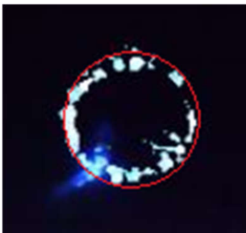
Rys. 77. Złożenie wielu zdjęć, ilustrujące ruch plamki po ekranie. Czerwony okrąg o średnicy 4,0 mm dodano dla ułatwienia oceny odwzorowania.
