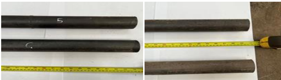
Rys. 2. Materiał do badań w postaci wycinków rur węzownic o wymiarach \varnothing 44,5 \times 7,5 mm i \varnothing 44,5 \times 5,2 mm i długości ok. 1770 mm ze stali SUPER 304H, po eksploatacji przez ok. 31 000 godzin w temperaturze 568^{\circ}\text{C} w kotle dużej mocy na parametry nadkrytyczne
