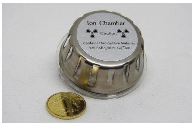
Rys. 1. Izotop ameryku-241 umieszczony w osłonie przeciw promieniowaniu \alpha (opracowanie własne)
