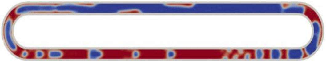
Rys. 1. Przykładowa dystrybucja płynu wewnątrz pulsacyjnej rurki ciepła
