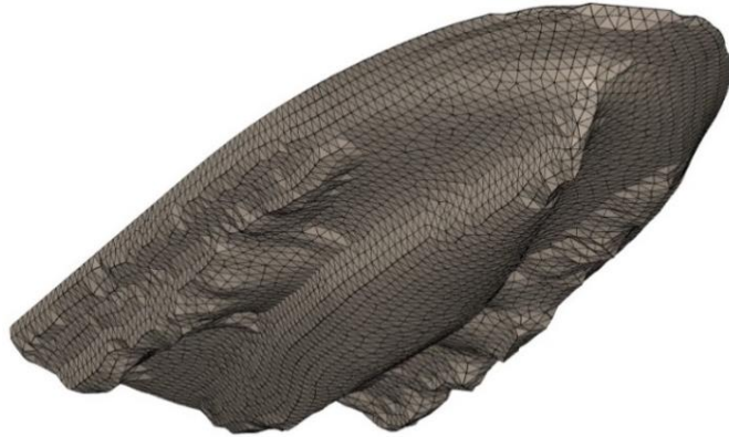
Rys. 2. Powierzchniowa siatka kadłuba dla Wrap/Target\ Size\ Control\ Ratio = 5
