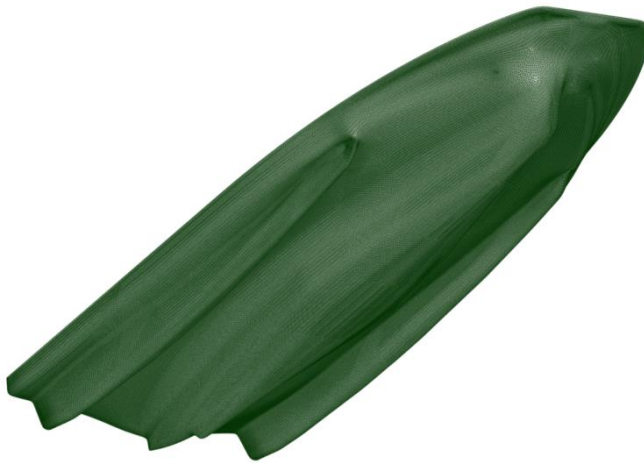
Rys. 1. Zaprojektowana geometria kadłuba łodzi solarnej Solaris II
