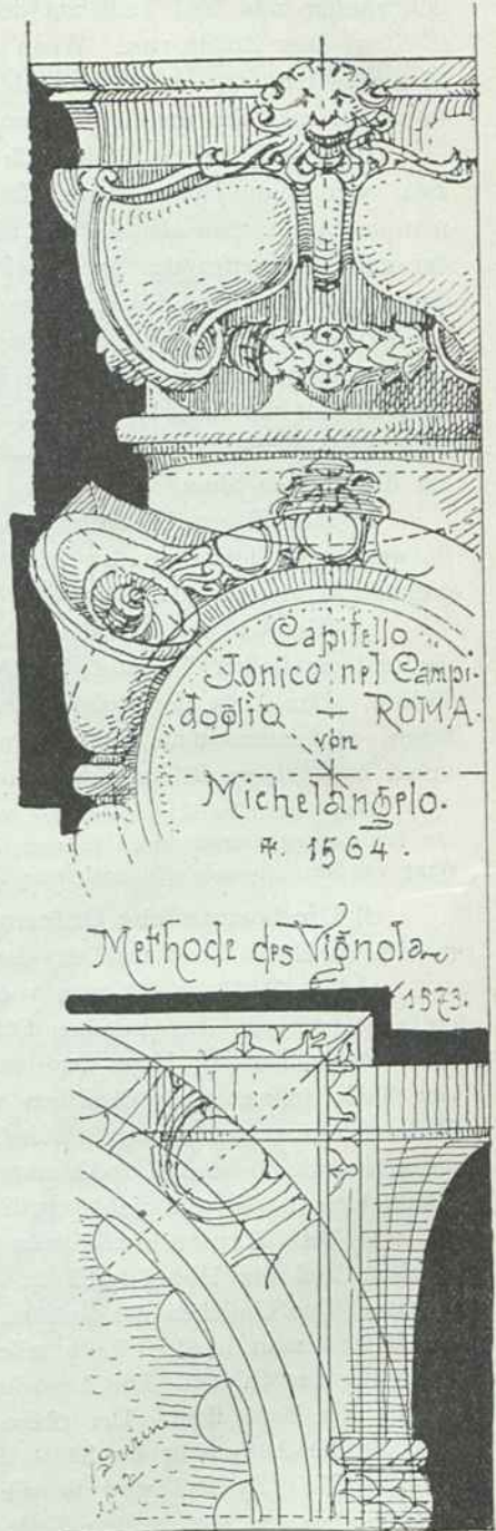
Zusammenstellung späterer jonischer Kapitellformen und Konfruktion einer Volute. (Abfatz c.)
