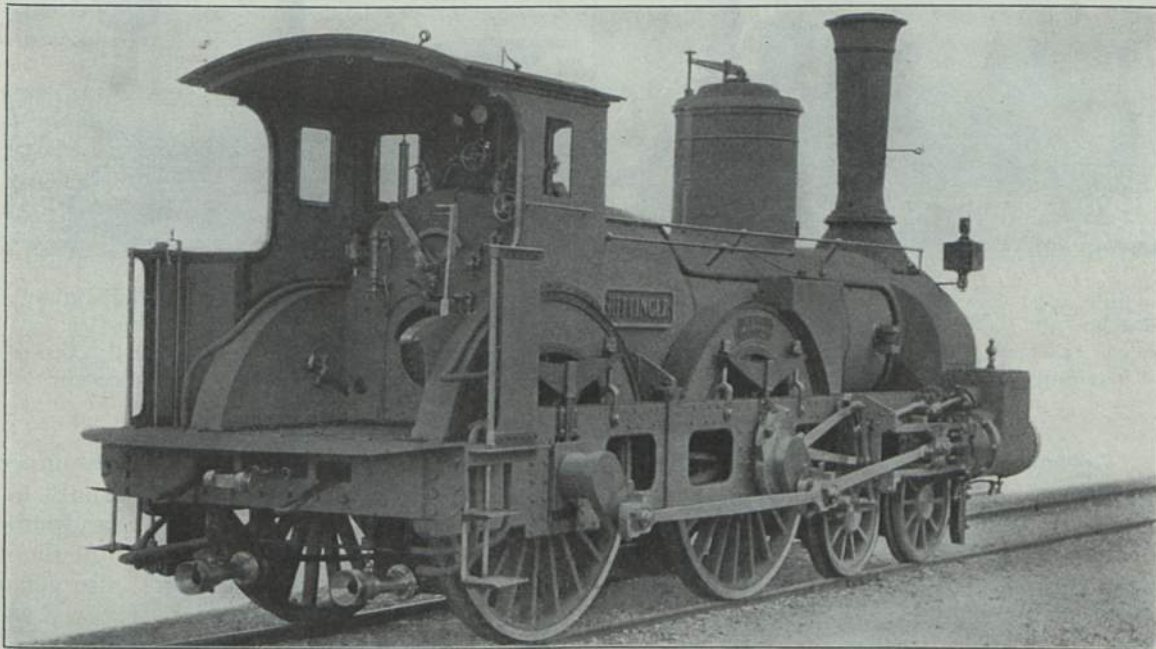
Abb. 302. „Rittinger“ Österreichische Nordwestbahn; Erb. Sigl-Wiener Neustadt 1873. 39,5 t; 23,0 t; 96,84 m 2 ; 1,64 m 2 ; 10,0 atü; 410 mm; 632 mm; 1900 mm; 5370 mm; 3550 mm.
