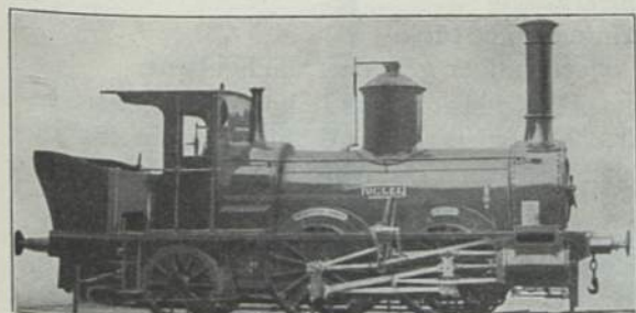
Abb. 261. „Uglei“ Altona-Kieler Bahn; Erb. Egestorff-Hannover 1866/67. 33,1 t; 24,7 t; 68,80 m 2 ; 1,02 m 2 ; 6,66 atü; 381 mm; 610 mm; 1524 mm; 3734 mm; 3220 mm; Wasser ~ 3,0 m 3 ; Kohlen ~ 1,0 t.
