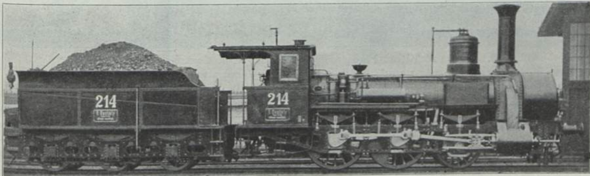
Abb. 147. Regelbauart II Ungarische Staatsbahn; Erb. Sigl-Wiener Neustadt ab 1869. 34,0 t; 23,0 t; 128,4 m 2 ; 155 m 2 ; 8,5 atü; 400 mm; 632 mm; 1516 mm; 3160 mm; 4200 mm.
