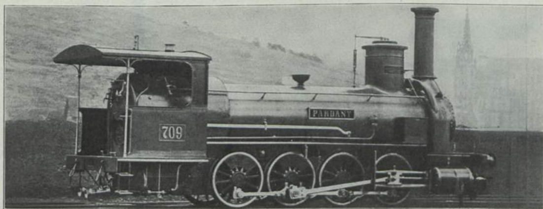
Abb. 410. „Pardany“ Österr. Staats-Eisenbahn-Gesellschaft; versch. Erb. u. a. Maschf. Eßlingen 1868/75. 44 t; 44 t; 166,2 m 2 ; 1,95 m 2 ; 9,0 atü; 470 mm; 632 mm; 1108 mm; 3793 mm; 5005 mm.
