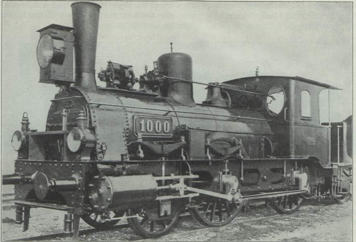
Abb. 238. „Maffei Nr. 1000“ Bayerische Staatsbahn; Erb. Maffei-München 1874/75. 33,5 t; 21,8 t; 91,0 m 2 ; 1,50 m 2 ; 10,0 atü; 406 mm; 610 mm; 1850 mm; 4270 mm; 3452 mm.
