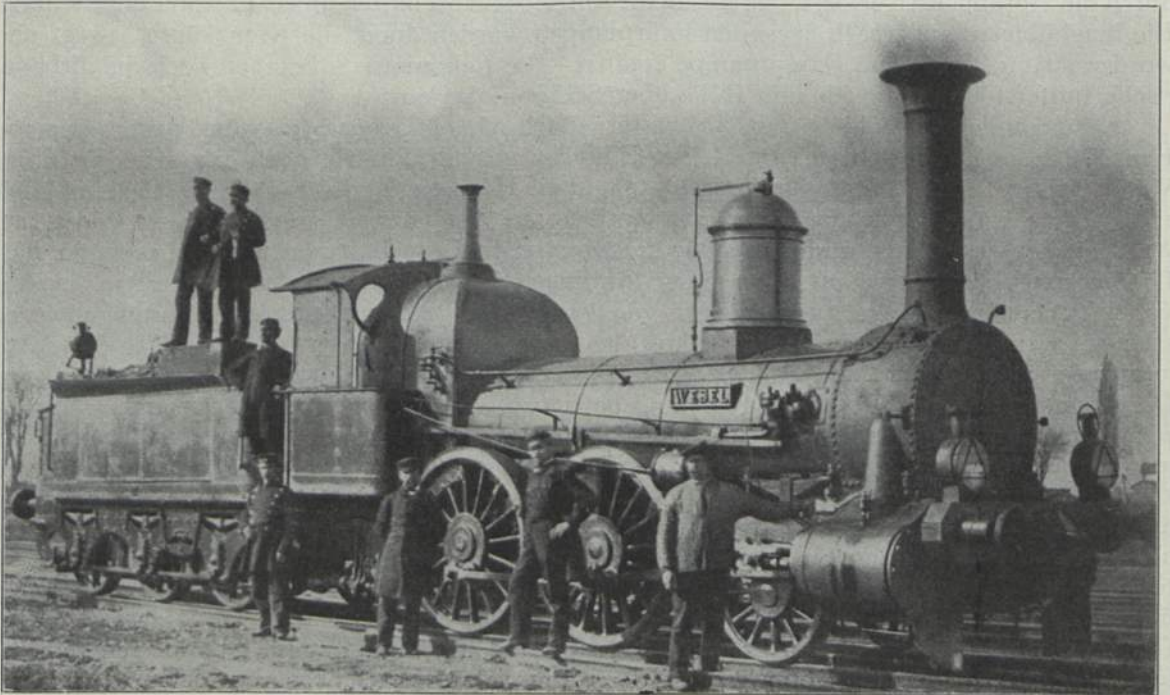
Abb. 100. „Wesel“ Köln-Mindener Bahn; Erb. Borsig-Berlin 1850/52. 32,5 t; 24,3 t; 95,97 m 2 ; 1,08 m 2 ; 7,14 atü; 432 mm; 559 mm; 1524 mm; 3348 mm; 4194 mm.
