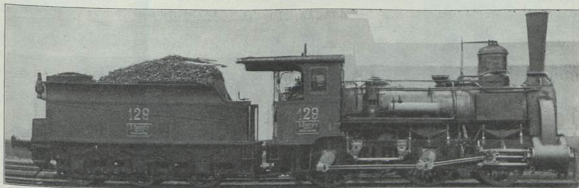
Abb. 236. Personenzuglokomotive Ungarische Staatsbahn; Erb. Sigl-Wiener Neustadt 1879. \sim 34 t; \sim 23 t; \sim 120 m 2 ; 1,55 m 2 ; \sim 9,5 atü; 400 mm; 632 mm; 1500 mm; 4300 mm; 4115 mm.
