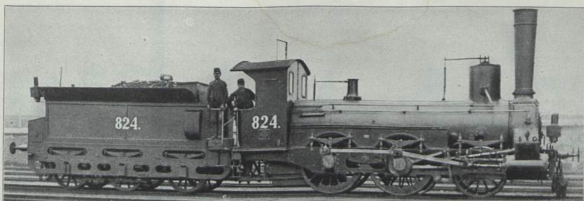
Abb. 143. „Betriebs-Nr. 824“ Alföld-Fiumaner Bahn; Erb. Maffei u. Krauß-München 1869. 35,0 t; 24,0 t; 105,68 m 2 ; 1,47 m 2 ; 8,0 atü; 411 mm; 632 mm; 1580 mm; 3477 mm; 3477 mm.
