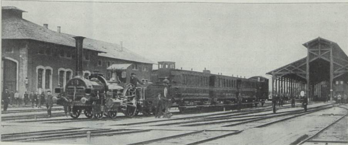
Abb. 43. „Pölnitz“ Pfalzbahn; Erb. Masch.-Fabr. Eßlingen 1855. 27,25 t 10,5 t; 79,83 m 2 ; 0,98 m 2 ; 7,23 atü; 381 mm; 610 mm; 1830 mm; 3960 mm; 3340 mm.
