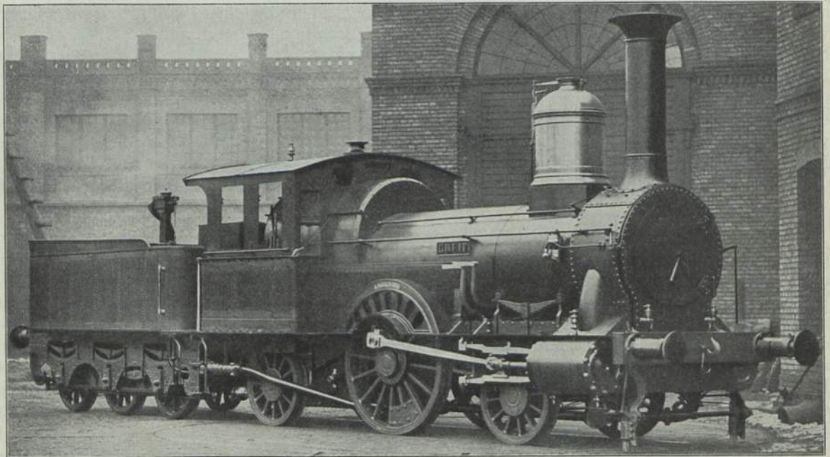
Abb. 59. „Greif“ Lübeck-Büchener Eisenbahn; Erb. Borsig-Berlin 1865. 30,75 t; 14,65 t; 83,33 m 2 ; 1,47 m 2 ; 7,14 atü; 406 mm; 508 mm; 1676 mm; 4237 mm; 3549 mm.
