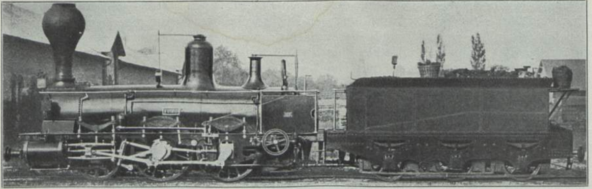
Abb. 135. „Juno“ Bayerische Staatsbahn; Erb. Maffei-München 1855. 30,0 t; 20,5 t; 90,20 m 2 ; 1,24 m 2 ; 8,0 atü; 406 mm; 610 mm; 1470 mm; 3050 mm; 3737 mm.
