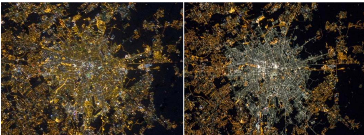
Fot. 12. Zmiana w barwie i jasności oświetlenia centrum Mediolanu przed (po lewej, 2012) i po modernizacji (po prawej, 2015) na technologię energooszczędną. Źródło: aut. Samantha Cristoforetti, NASA/ESA, https://www.media.inaf.it/2015/08/12/linquinamento-luminoso-studiamolo-dallo-spazio/
