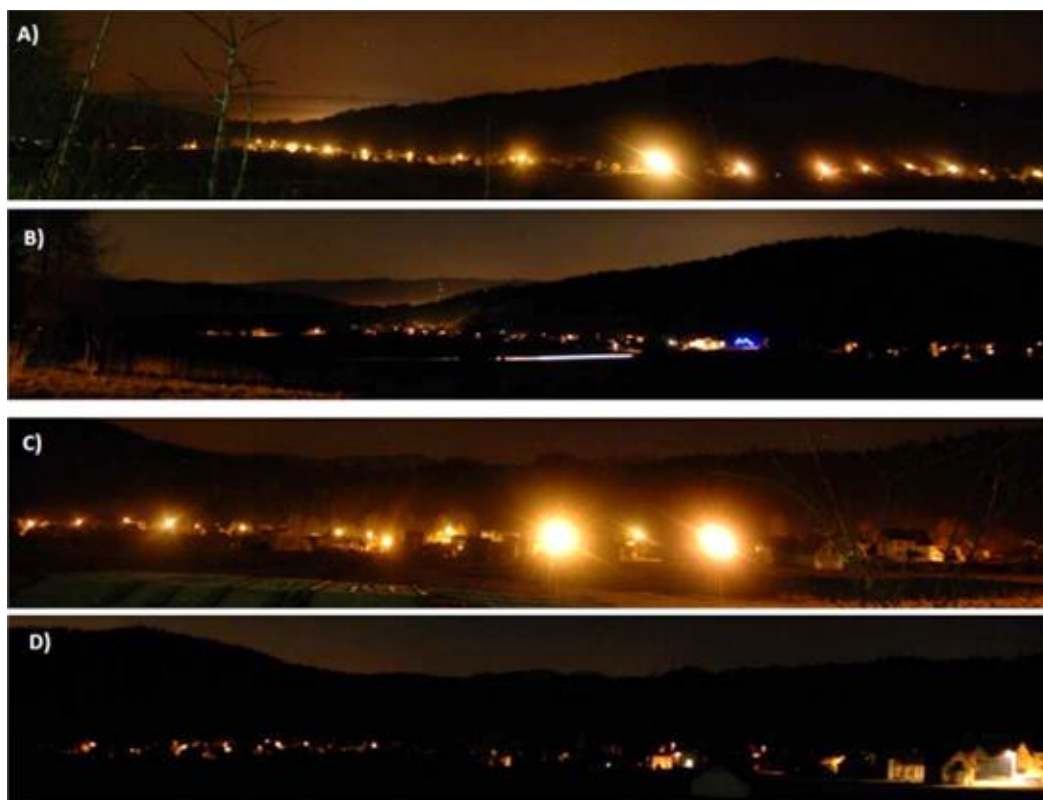
Fot. 16. Jakość nocnego nieba i sytuacja oświetleniowa przed (A i C) i po (B i D) modernizacji. Fotografie porównawcze. Źródło: www.ciemnieniebo.pl/
