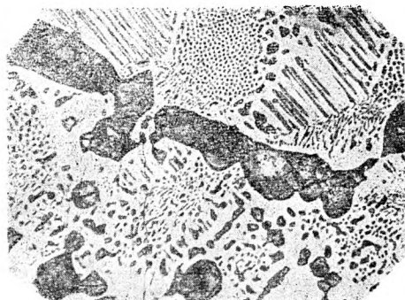
Rys. 20. Przekrój 50 % Co, 9 % P, chłodzone w piecu, trawione rozcieńczonym \text{HNO}_3 ; pierwotnie: \gamma (rozpadnięte przy przemianie \gamma \rightarrow \alpha ); eutektyka: \alpha + (\text{Fe}, \text{Co})_3\text{P} (częściowo rozpadnięte)
