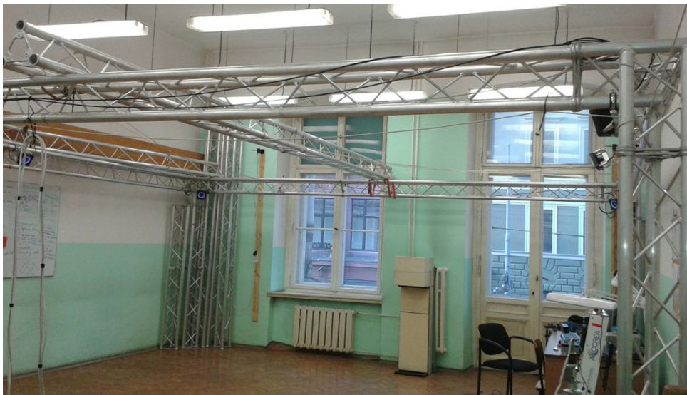
Rysunek 4.12 Pomieszczenie w którym realizowano eksperymenty wraz metalową konstrukcją, do której zamontowano kamery systemu śledzenia ruchu OptiTrack
