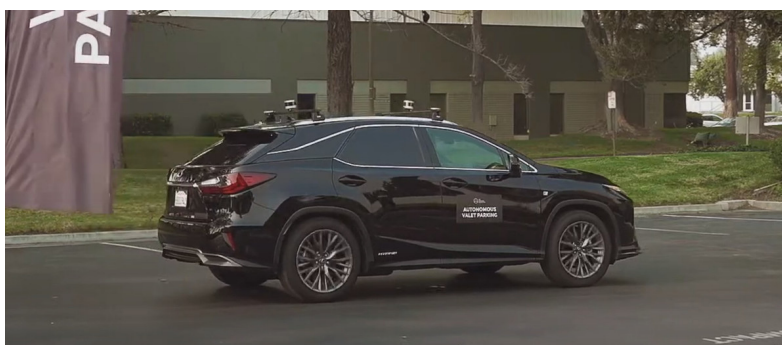
Rysunek 1.2 Autonomiczny samochód wyposażony w zestaw sensorów oraz system Autoware Auto [71] realizujący zadanie autonomicznej nawigacji. System został zaimplementowany w środowisku ROS 2 [201], który docelowo będzie się komunikował z innymi pojazdami oraz elementami infrastruktury
