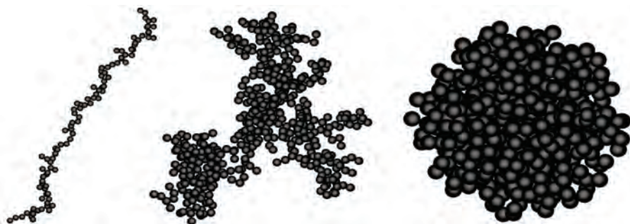
Rys. 2.2. Przykładowe modele agregatów o odmiennym wymiarze fraktalnym, kolejno od lewej: D_f = 1.3 , D_f = 2.0 , D_f = 2.8
