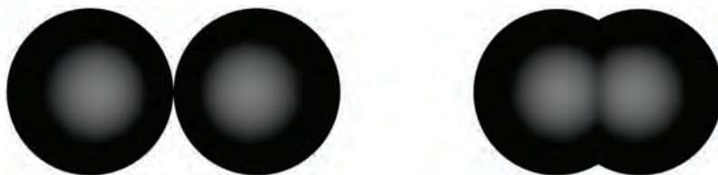
Rys. 2.11. Klaster złożony z dwóch cząstek. Współczynnik przenikania to (od lewej) C_a = 0.0 , C_a = 0.5
