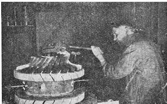
Rys. 14. Ręczne wyginanie na gorąco łopatek wirnika wyginarką rolkową.
