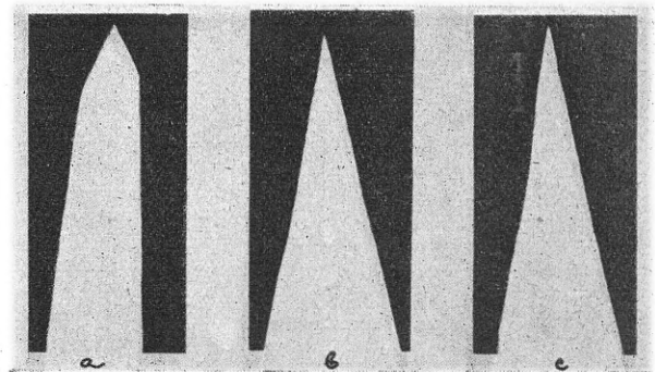
Rys. 17. Wpływ rodzaju zaostrenia na zdolność krajania a — zaostrenie na kamieniu, b — zaostrenie na maszynie do ostrzenia i c — zaostrenie na specjalnym aparacie.
