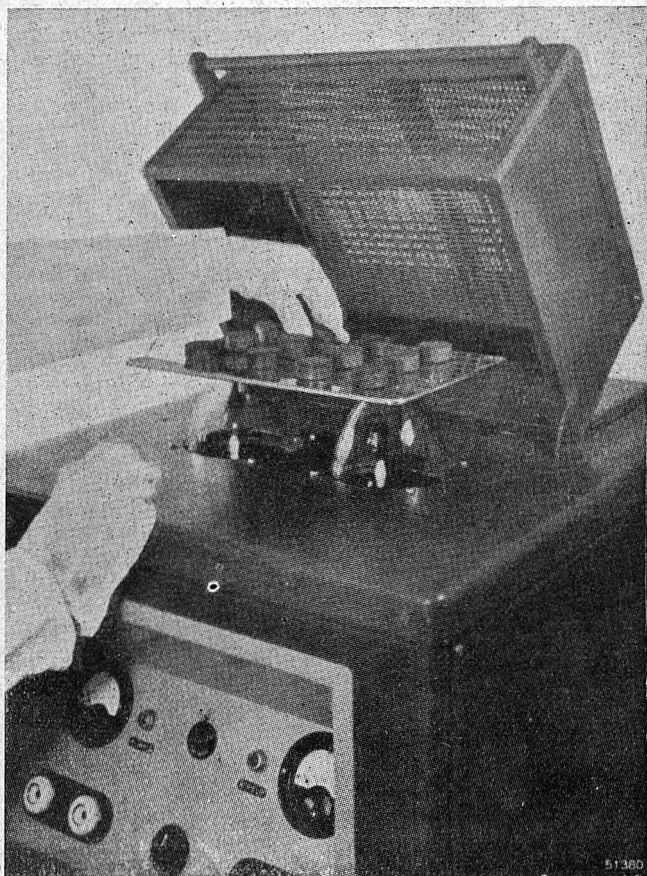
Rys. 1. Generator dielektryczny o mocy 2 kW do wstępnego podgrzewania mas plastycznych (Philips)
