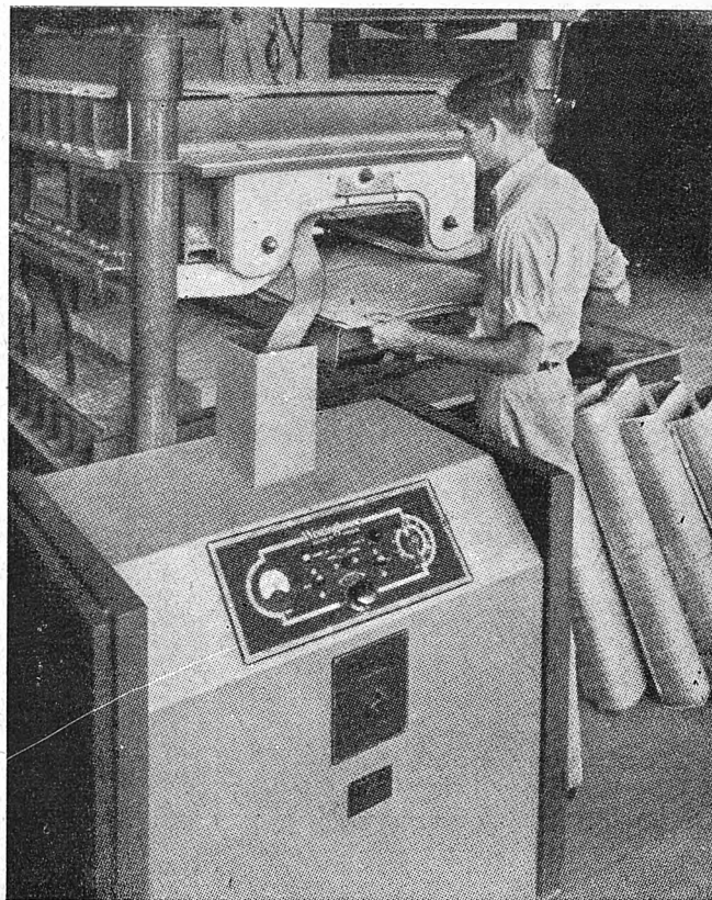
Rys. 10. Formowanie i sklejanie dyktów grzejnikiem wielkiej częstotliwości. Operacja trwa 120 sekund przy mocy generatora 5 kW (według Westinghouse Engineer, September 1948)
