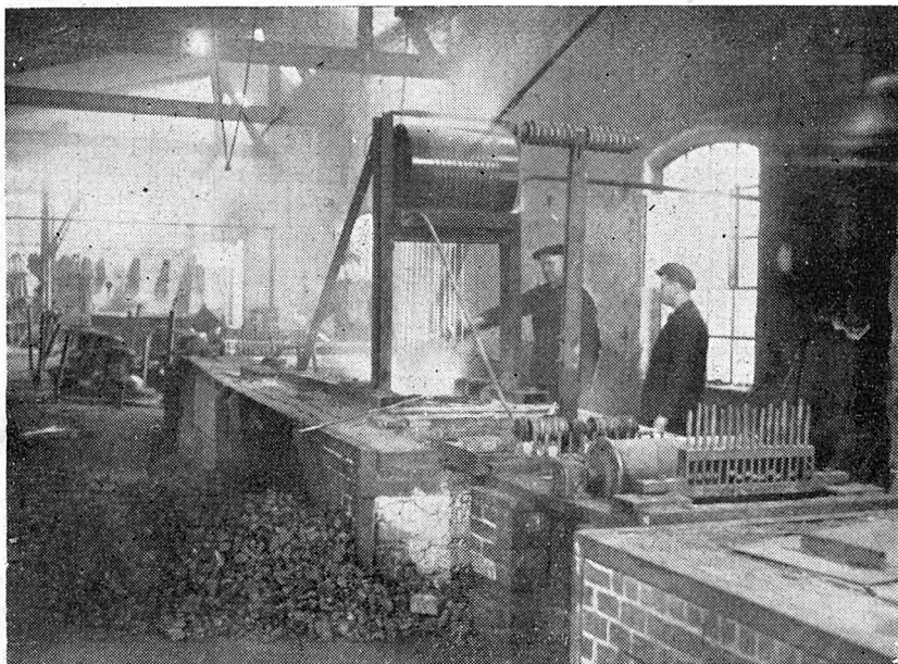
Rys. 2. Piece i urządzenia do pionowego cynkowania drutu
