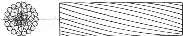
Rys. 1. Przewód roboczy stalowo-aluminiowy (86 + 377) mm 2
