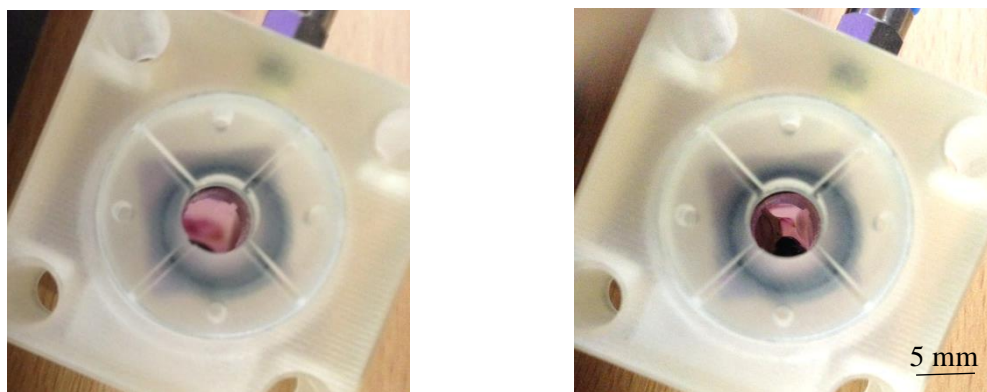
Rysunek 3.12 Krzemowa membrana w polimerowej obudowie przed (po lewej) i podaniu ciśnienia P = 100 kPa (po prawej). Ugięcie membrany wynosiło 105\ \mu\text{m}
