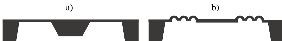
Rysunek 3.5 Schemat przekroju membrany: a) ze wzmocnieniem ( bossed ) oraz b) pofalowanej
