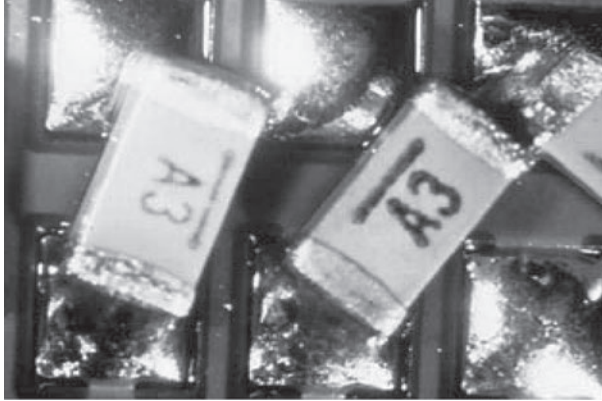
Rys. 9.14. Błąd niewłaściwego osadzenia elementów [4]
