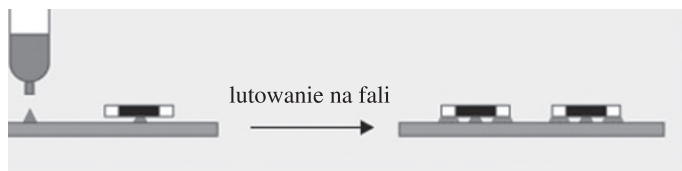
Rys. 11.1. Stosowanie kleju strukturalnego przed procesem lutowania na fali wg [32]
