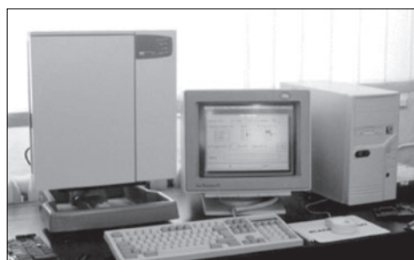
Rys. 10.7. Jonograf CM11 Multicore do pomiaru poziomy zanieczyszczeń jonowych [30]
