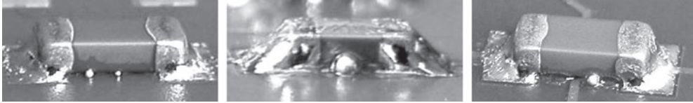
Rys. 9.16. Kulki lutu pod kondensatorami ceramicznymi 1206 i 0805 [18]
