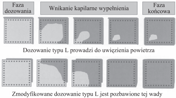
Rys. 4.25. Możliwość uwężnienia powietrza przy niewłaściwej konfiguracji dozowania kompozytu [4]
