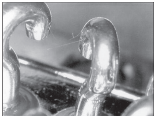
Rys. 9.23. Zwarcie wiskerami pomiędzy wyprowadzeniami [27]
