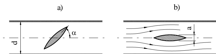
Rys. 7.22. Schemat przepustnicy: a) uchylonej, b) otwartej
