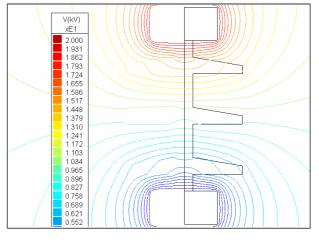
Fig. 3.27: Equipotential lines of an insulator
