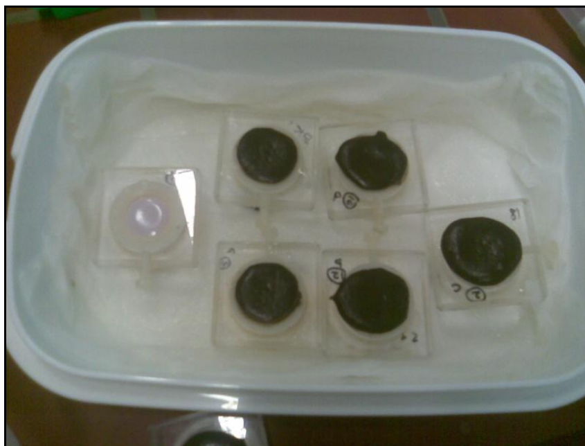
Zdjęcie 8. Urządzenia DGT z nałożonymi próbkami gleby, bezpośrednio przed poddaniem powtórnej inkubacji (zdjęcie własne)
