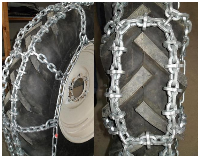
Rys. 4.16. Widok łańcucha antypoślizgowego po zamontowaniu na badanej oponie
