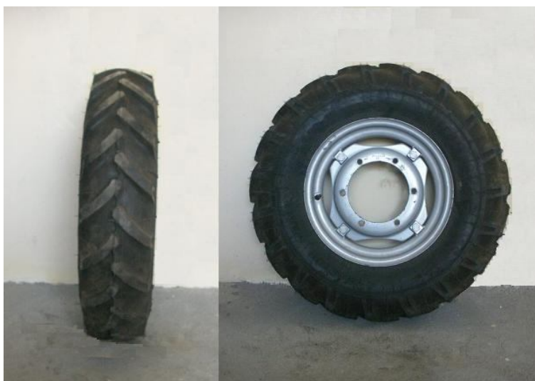
Rys. 4.14. Widok opony 7.5-16 użytej podczas I i II etapu badań
