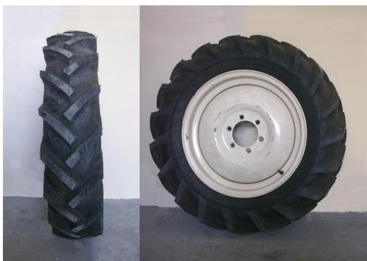
Rys. 4.15. Widok opony 8.3-20 użytej podczas II etapu badań
