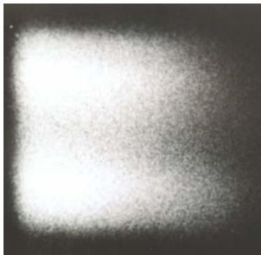
Rys. 6.2. Jarząca się plazma w kanale lasera falowodowego CO 2 wzbudzanego poprzecznie prądem w.cz. [6.14]
